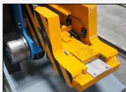
Elektromechanické polohovanie pätky pod záťažou
