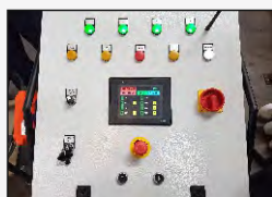
Rádiové ovládanie zdvihu + LCD displej
