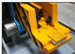
Elektromechanické polohovanie pätky pod záťažou
